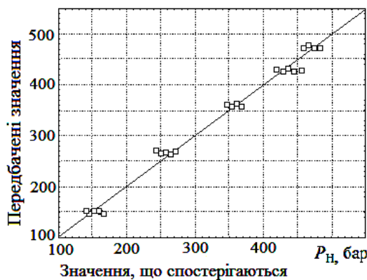
Рис. 3. Положення значень, що спостерігаються на лінії рівних величин p_n для навантажувальної характеристики: □ – значення, що спостерігаються
