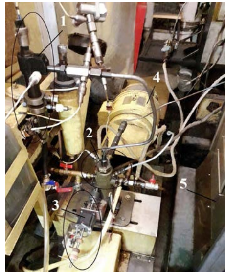
Рис. 1. Безмоторний стенд для дослідження паливної апаратури: 1 – форсунка; 2 – паливний насос високого тиску (ПНВТ); 3 – пристрій, що керує переміщенням рейки ПНВТ; 4 – електродвигун; 5 – станція управління електродвигуном
