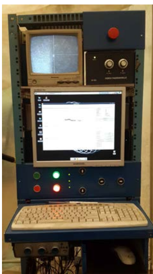
Рис. 6. Система керування лабораторного стенда для експериментальних досліджень з лазерного зварювання кільцевих зварних з'єднань з різномірних сталей у вертикальному просторовому положенні
